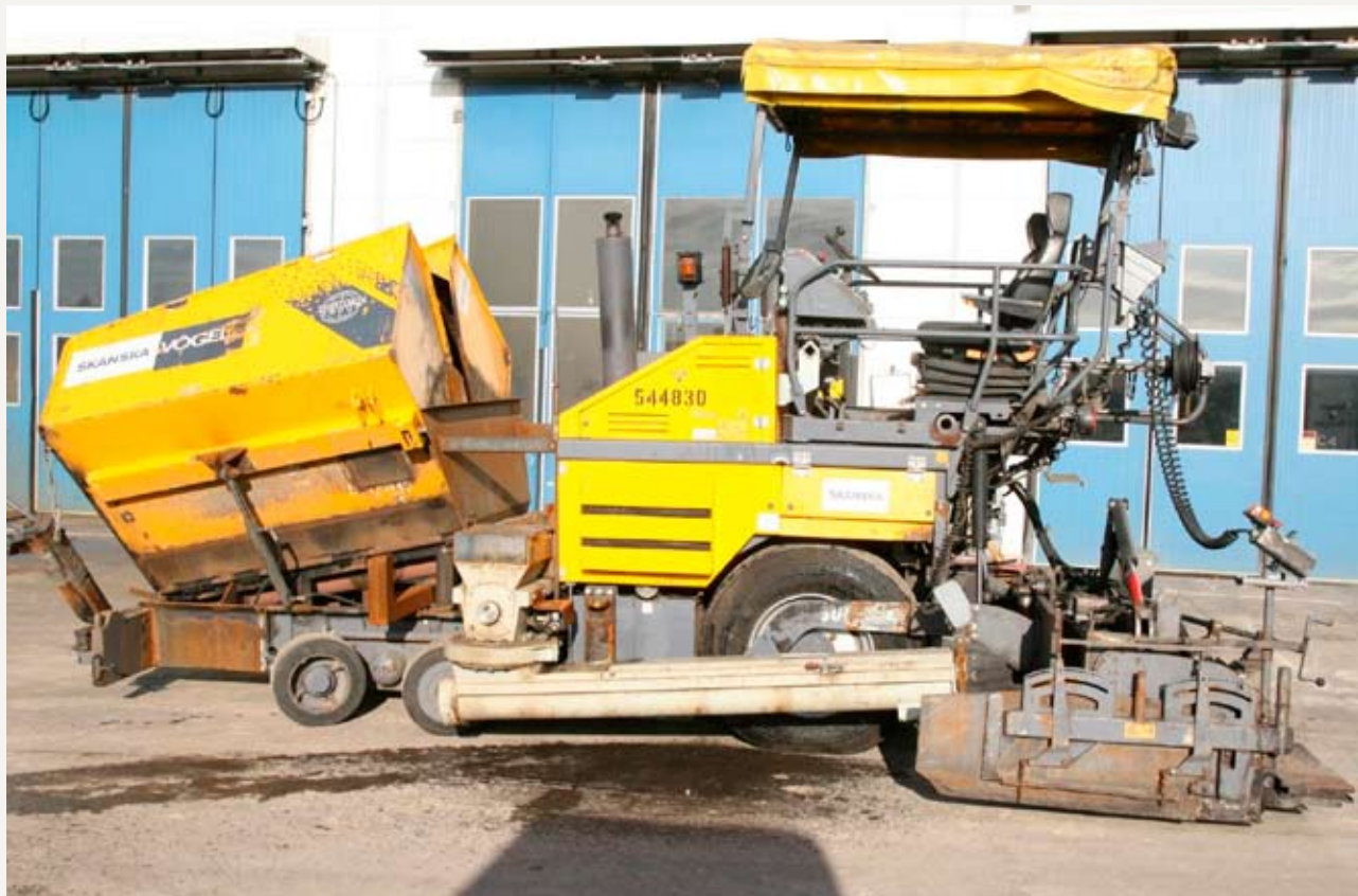
Det är i grunden en Vögele 1203. Vi har byggt om tråget och satt en spriderskruv i botten. Halva skriden är nerlockad och bomberingen är ombyggd. Skriden går att skjuta i sidled så att den hamnar helt vid sidan om maskinen. All automatik som fanns på maskinen har vi tagit vara på.
